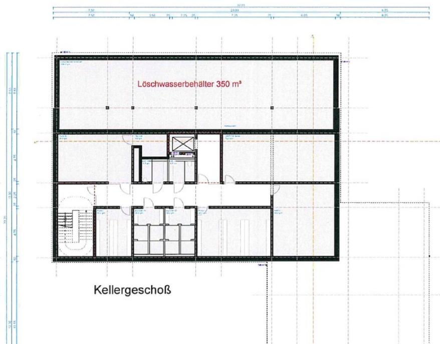
Direkt neben dem Kellergeschoß wird der Löschwasserbehälter westlich an der Außenwand angrenzend in massiver Betonbauweise mit entsprechenden Abdichtungsmaßnahmen errichtet. Durch die direkte Anbindung an das Verwaltungsgebäude entstehen u. a. folgende Synergieeffekte:
