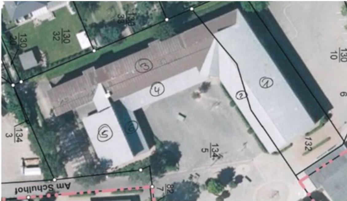
Herr Boguhn erläutert, dass im Zuge der begonnen Dachsanierungsarbeiten (Entsorgung der asbestbelasteten Dachflächen – Fläche Nr. 3) an der Goode-Weg-Schule auch die restlichen Dachflächen in Augenschein genommen wurden. Dabei wurde durch eine Fachfirma festgestellt, dass ca. 700 Faserzementplatten der restlichen Dachfläche Beschädigungen (Risse und Undichtigkeiten) aufweisen und ausgetauscht werden müssen.
